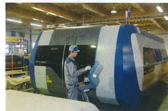
ファイバーレーザー加工機。複雑で精密な最新鋭の加工機械も若手社員が中心となり、稼働させています
